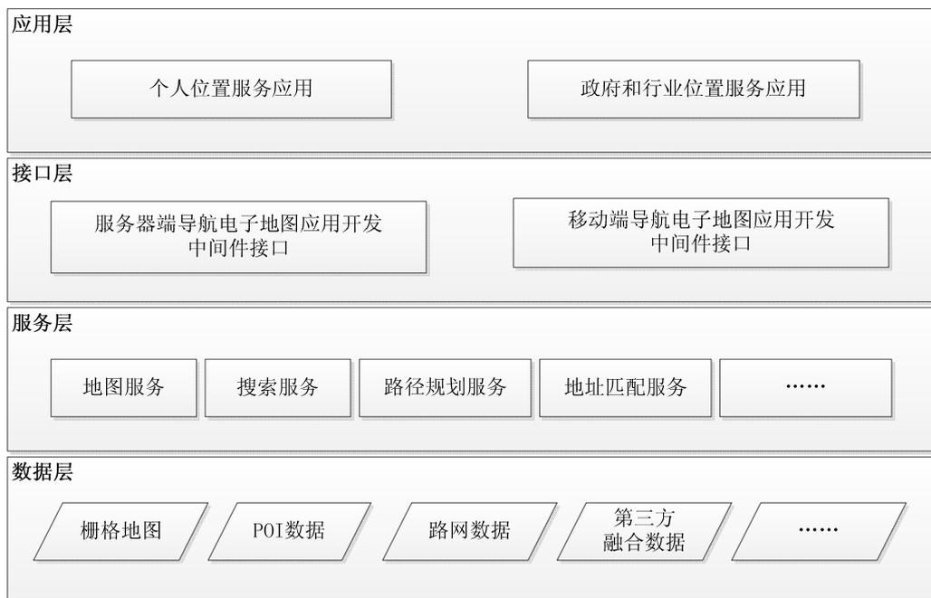
图 1 GNSS 导航电子地图应用开发中间件接口关系图
