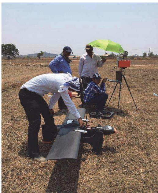
图 32 北斗高精度接收机应用于柬埔寨无人机
